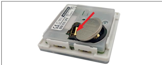
Abb. 6 Neue Batterie einsetzen
