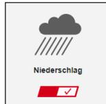
Die Niederschlagsüberwachung dient dazu, den außenliegenden textilen Sonnenschutz und auch Fenster bei Niederschlag zu schließen bzw. einzufahren.
