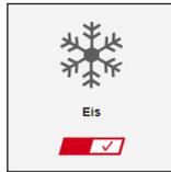
Um den außenliegenden Sonnenschutz vor Beschädigung durch Vereisung z. B. der Führungsschienen zu schützen kann die Sicherheitsfunktion Eisüberwachung genutzt werden. Wird bei kalten Außentemperaturen Niederschlag erfasst wird die Anlage in die Sicherheitsstellung gefahren und dort gesperrt. Nachdem der Nutzer überprüft hat, dass die Anlagen frei von Eis sind kann der Eisalarm manuell beendet werden.
