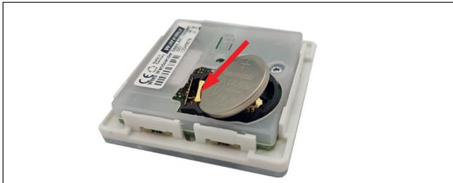
Abb. 6 Neue Batterie einsetzen
