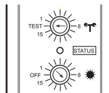
**Die Schalter an der Wetterstation einstellen:** Der Schalter "WIND" befindet sich in der Stellung "TEST", der Schalter "Helligkeit" befindet sich in einer beliebigen Stellung, nicht jedoch in der Stellung "OFF".
