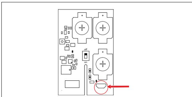
Abb. 9 USB-Buchse zum Laden der Akkus im Ausnahmefall
